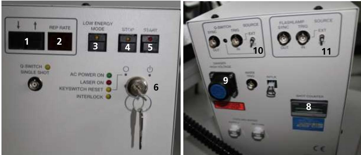
Bild 4.1 Fotos der Vorder- (links) und Rückseite (rechts) der Laserstrahlquelle, 1 Schalter für die Wahl der Repetitionsrate, 2 Anzeige der gewählten Repetitionsrate, 3 Schalter für den Low Energy Mode, 4 Stoppschalter, 5 Startschalter, 6 Schlüsselschalter, 7 Status-LEDs, 8 Pulszähler der Blitzlampe, 9 Anschluss der Verbindungsleitung, 10 und 11 Konfiguration der Triggerung von Güteschalter und Blitzlampe
