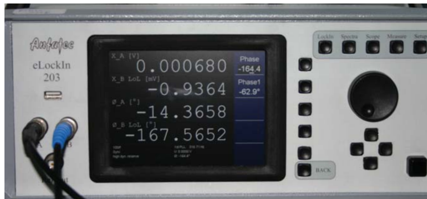
Abbildung 28: Doppel-Lock-In-Stufe zur rauscharmen Aufnahme der Messsignale von der Diodenbrücke
