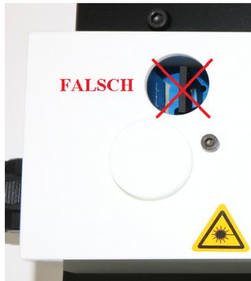
Abbildung 10: In dieser Position der  $\frac{\lambda}{2}$ -Platte werden Photonen im EPR-Zustand erzeugt, somit nicht geeignet für die Messung nicht-verschränkter Photonenzustände.
