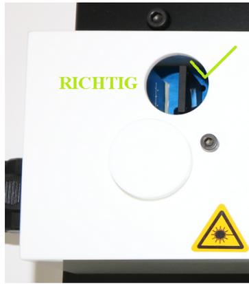
Abbildung 12: Lambda-Halbe-Platte innerhalb des Strahlengangs. Es werden Photonen im EPR-Zustand erzeugt. Die Quelle ist nach schließen des Gehäuses bereit zur Messung polarisationsverschränkter Photonen.
