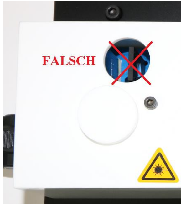
Bild 7: Lambda-Halbe-Platte innerhalb des Strahlengangs. Es werden Photonen im EPR-Zustand erzeugt. Die Quelle ist so nicht für die Messung nicht-polarisations-verschränkter Photonen geeignet.
