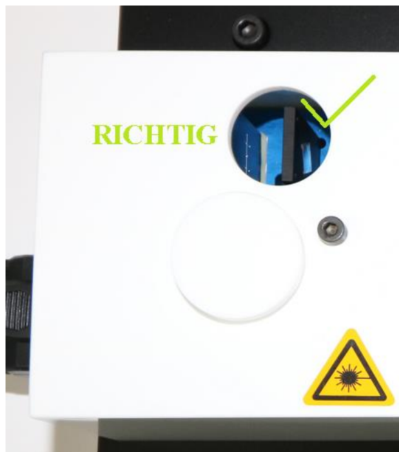
Bild 8: Lambda-Halbe-Platte innerhalb des Strahlengangs. Es werden Photonen im EPR-Zustand erzeugt. Die Quelle ist nach schließen des Gehäuses bereit zur Messung polarisationsverschränkter Photonen.
