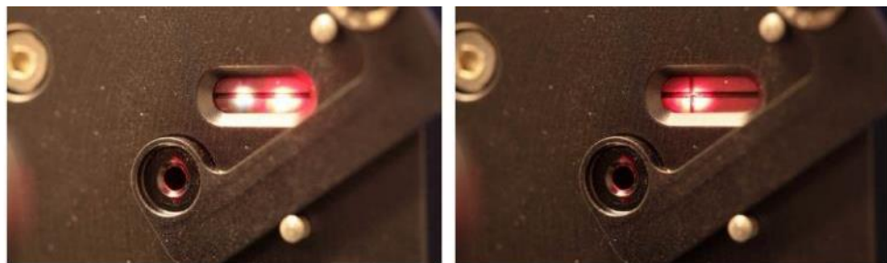
Bild 27: Alignment Window des PulseCheck. Laserstrahl falsch justiert (links), richtig justiert (rechts); aus [11].
