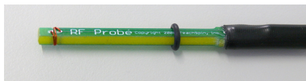
Abbildung 20: Leiterschleife zur direkten Ausmessung der RF-Pulse. Mit Hilfe des Gummiringes kann sie in der Höhe fixiert werden.
