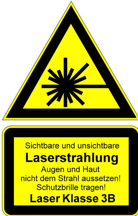
Der Laser darf nie unbeaufsichtigt in Betrieb sein. Ungewollte Strahlreflexionen in den Raum (z. B. durch Armbanduhren) sind zu vermeiden!
